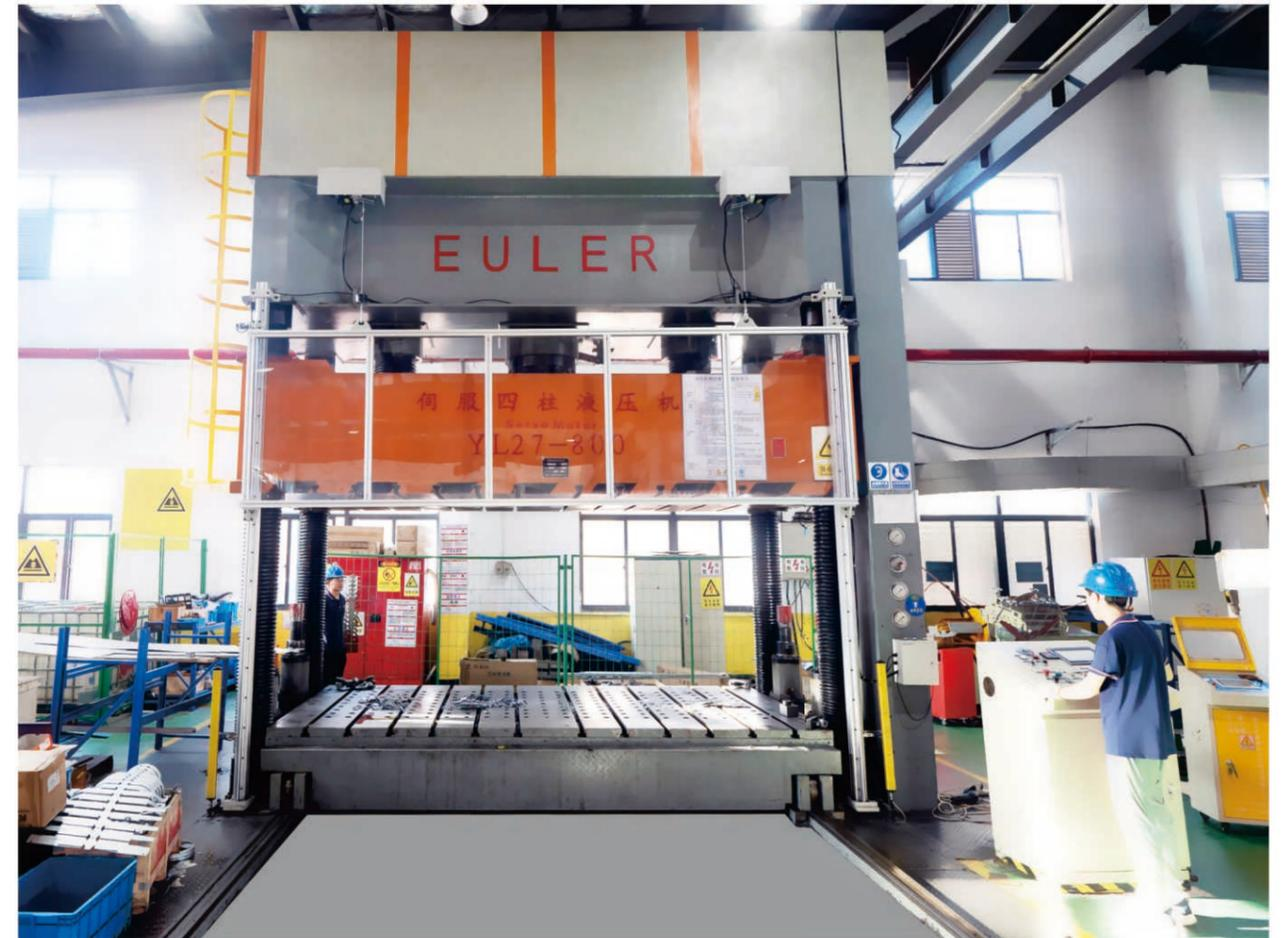
800吨伺服液压机(4500mm\*2000mm) 800T Servo Press (4500mm\*2000mm)
